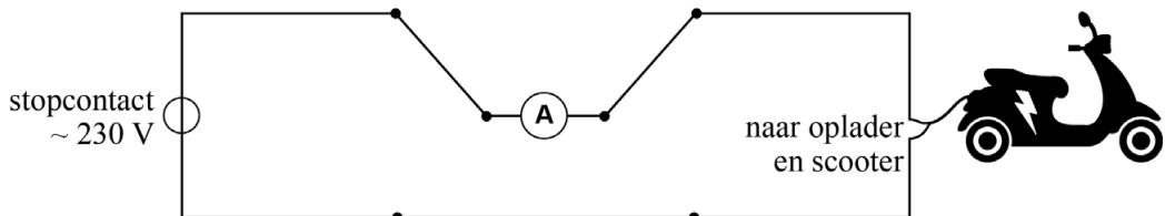
stroommeter in serie met de oplader geplaatst en schakeling gecompleteerd
